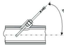
Sonda di temperatura perpendicolare all'asse del tubo
