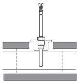
L'isolamento può essere realizzato fino al collegamento a vite della sonda di temperatura.
