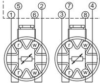
Sezione del cavo per le sonde a testina  $\geq 0,5 \text{ mm}^2$  (EN 1434-2)
