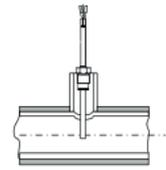
Elemento della sonda di temperatura immerso nell'asse del tubo
