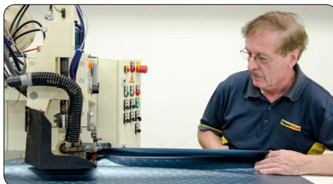
Verschweissen der Kunststoffbahnen mit dem Heizkeilschweissgerät
