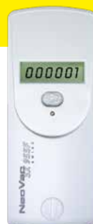
Funk-Heizkostenverteiler NeoVac SX 955F
