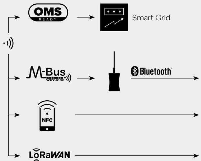
Infrastrukturen eingebunden werden. Die Datenabfrage per Funk für Walk-by, Drive-by und stationäre Systeme, zum Beispiel bereits vorhandene Elektrozähler, ist ohne Neueinstellung möglich. Zudem enthalten die Wasserzähler der Reihe NeoVac Ultrimis W den Kommunikationsstandard NFC für detaillierte Informationen über den Verbrauch sowie den aktuellen Wasserzählerstand.
